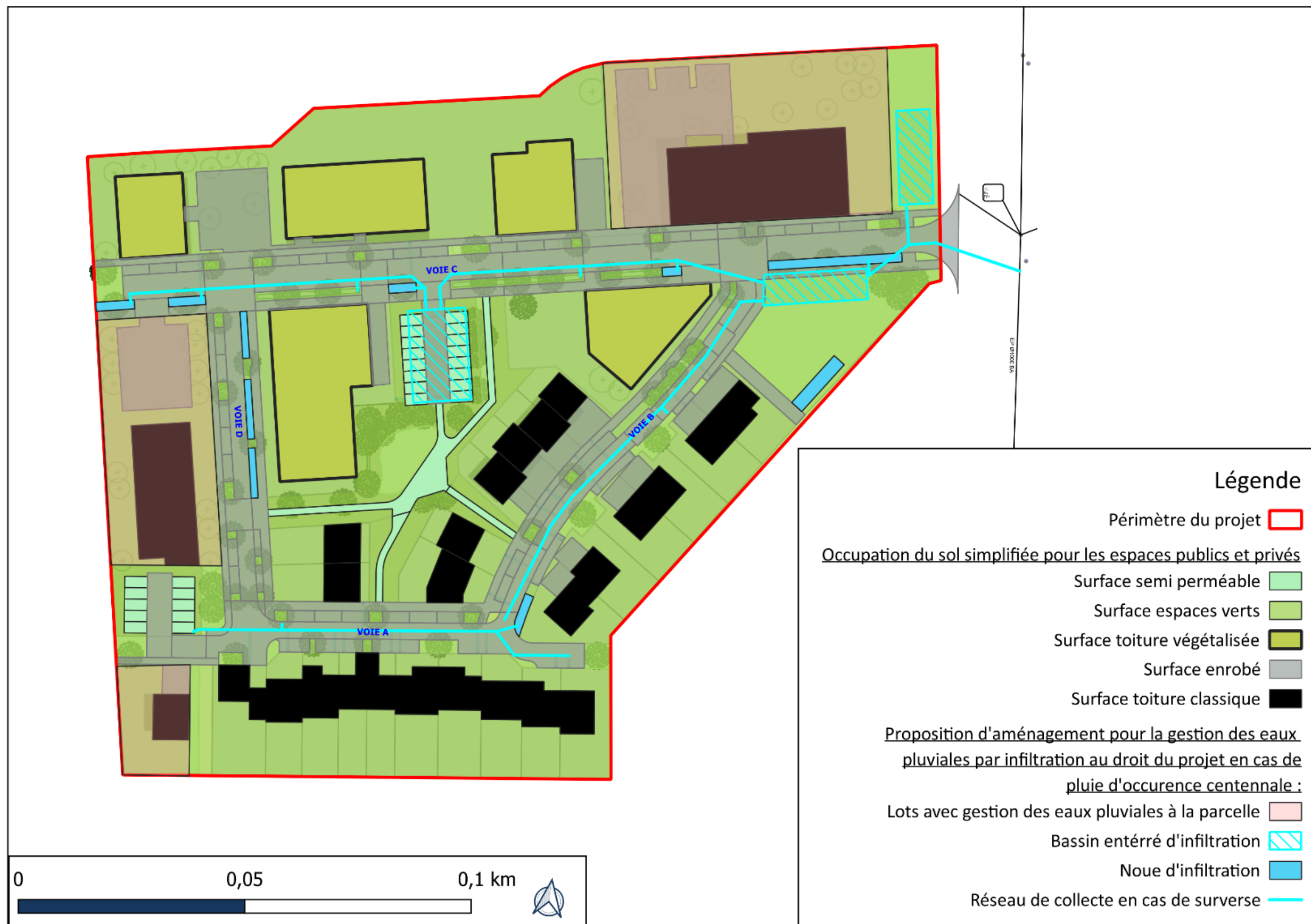
Schéma 15 : Principes d'assainissement pluvial retenus pour le projet d'aménagement La Folie Couvrechef
