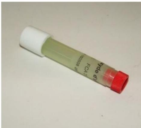
Echantillonneur passif pour le dioxyde d'azote (Passam Ag)
