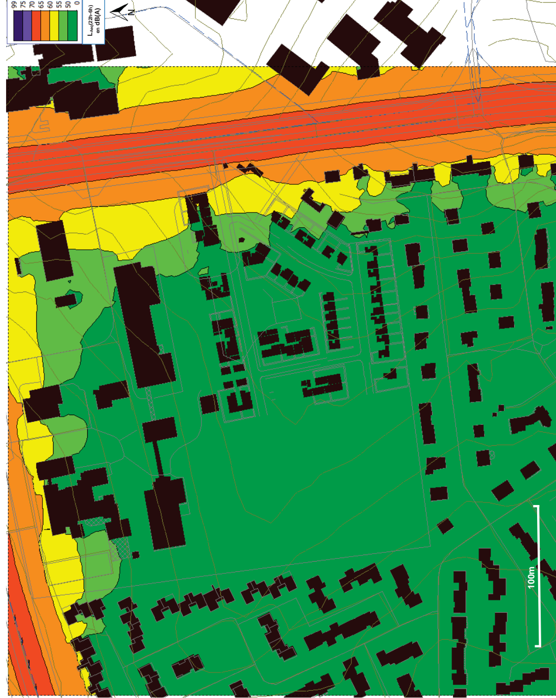
Ambiance sonore nocturne prévisionnelle avec classement réglementaire, en dB(A), à hauteur constante de 4m par rapport au sol
