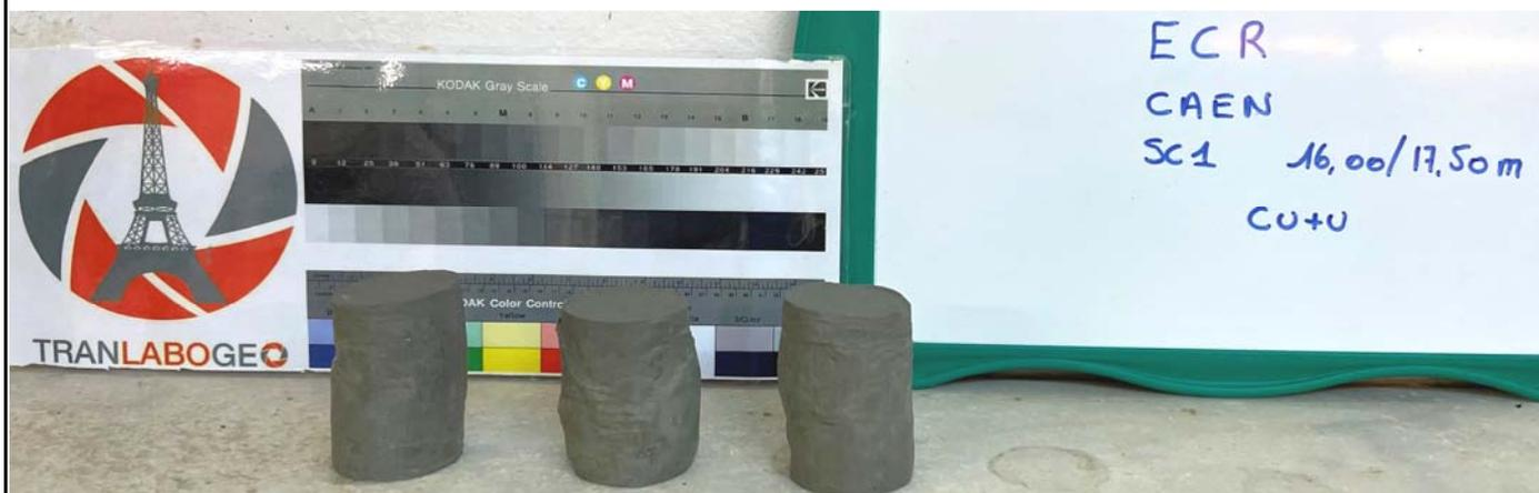
ESSAI TRIAXIAL CONSOLIDE NON DRAINE CU + u NFP 94-074
