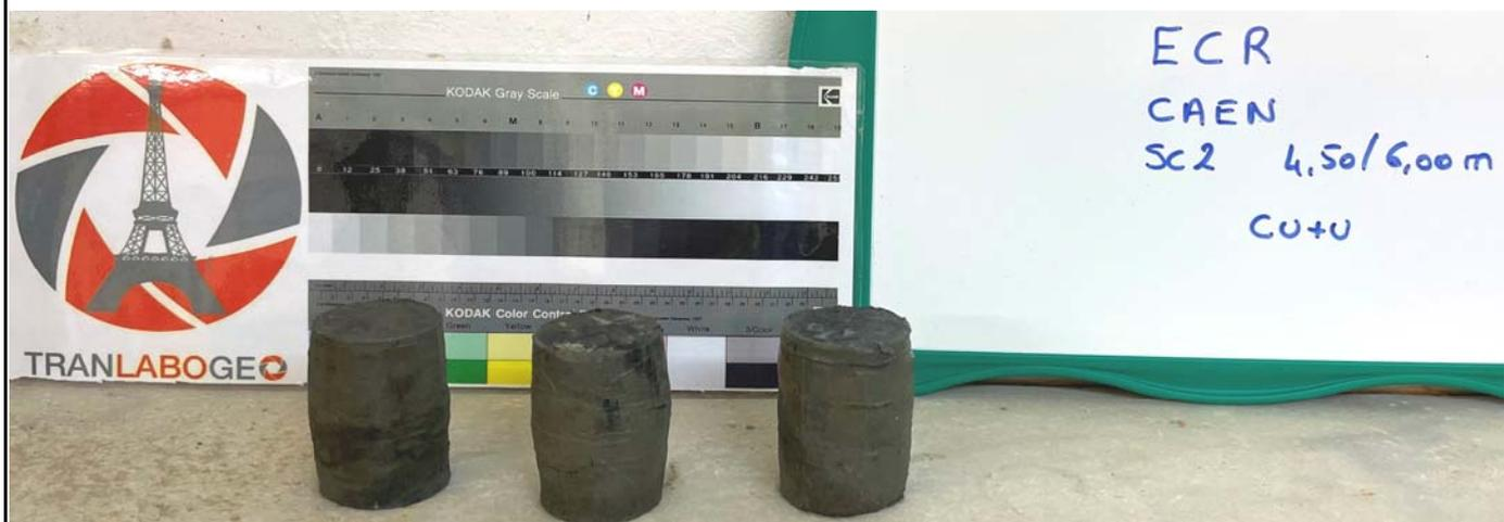
ESSAI TRIAXIAL CONSOLIDE NON DRAINE CU + u NFP 94-074
