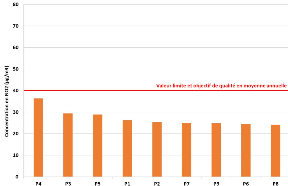
Figure 14 : comparaison des résultats des mesures NO<sub>2</sub> à la réglementation
