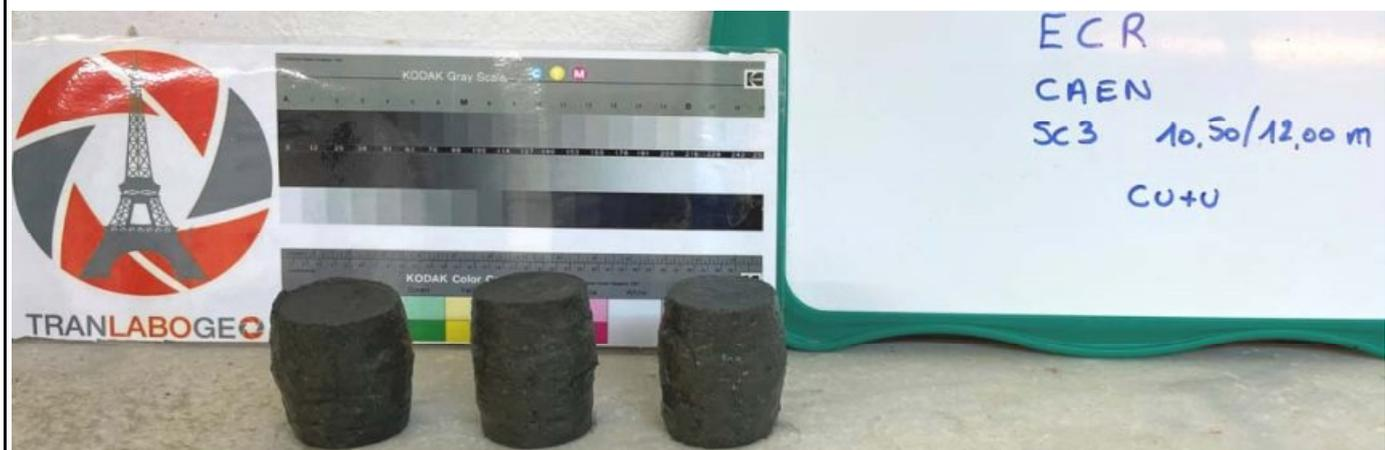
ESSAI TRIAXIAL CONSOLIDE NON DRAINE CU + u NFP 94-074
