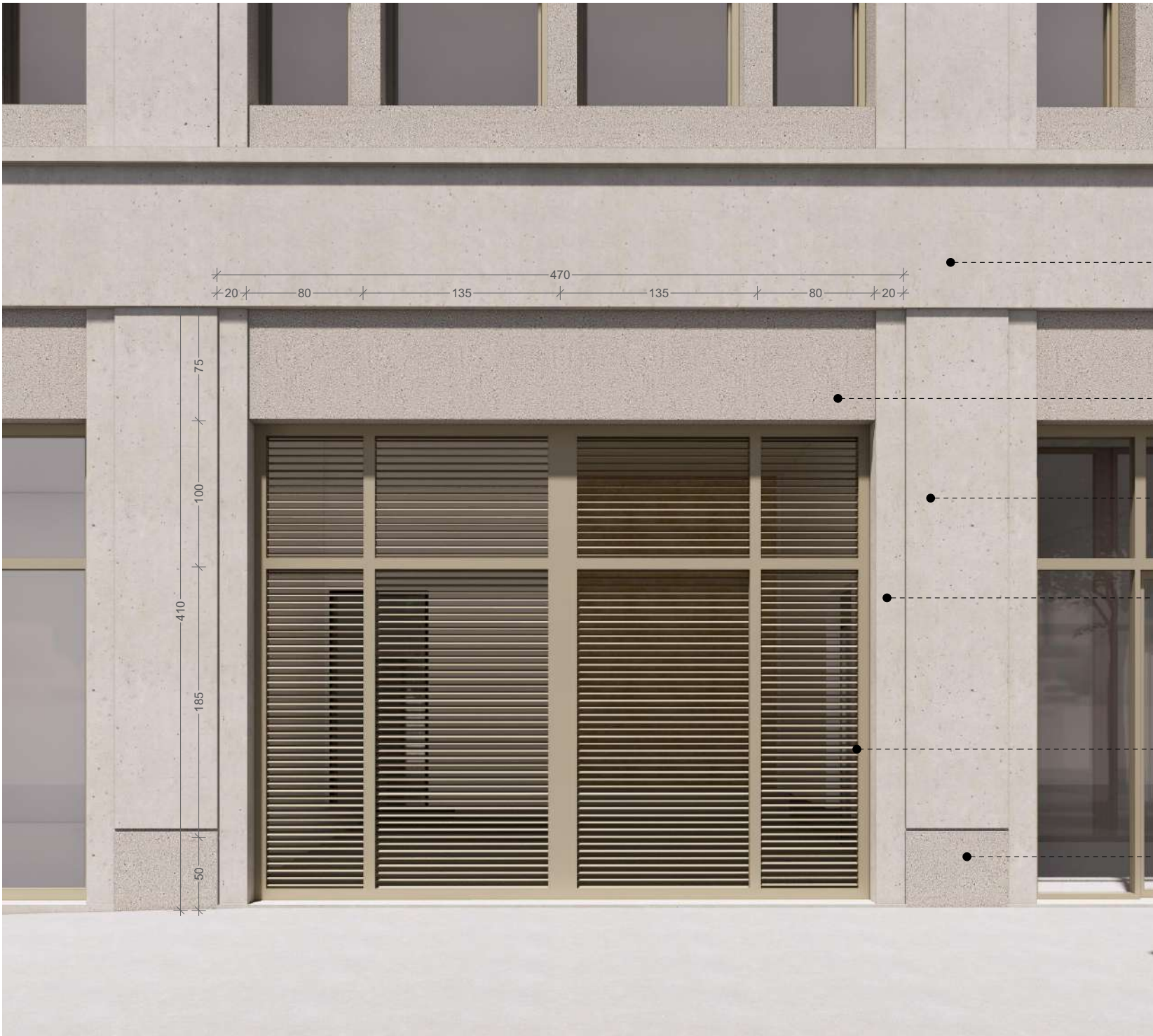
Socle _ Traitement du socle du bâtiment DE _ Locaux techniques
