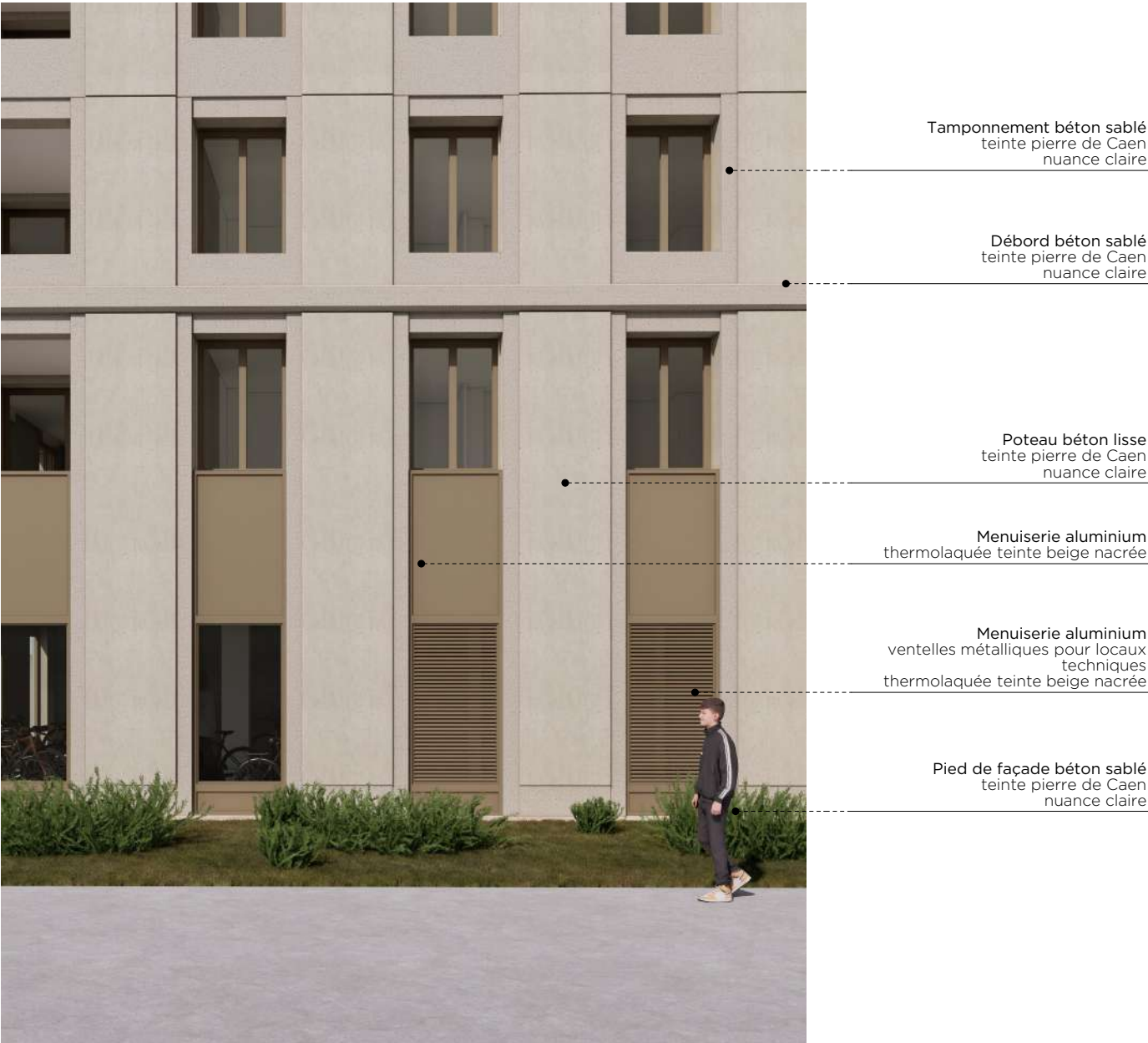
Le principe d'intégration des locaux techniques
